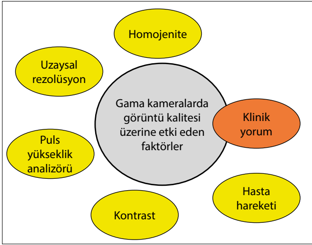
Şekil 2. Gama kameralarda görüntü kalitesine etki eden faktörler.
