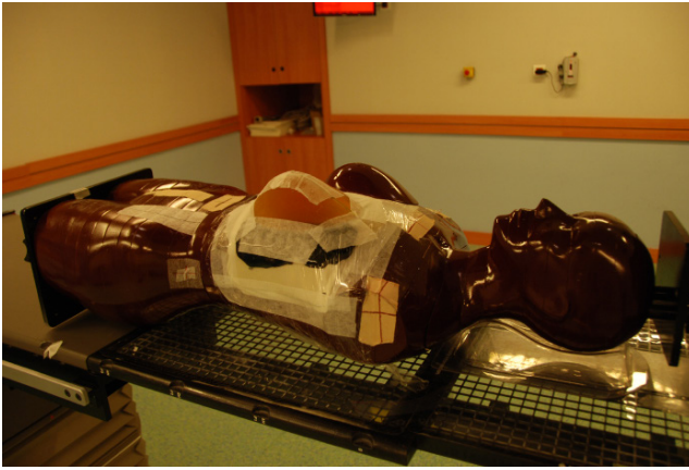
Şekil 3: Sagittal kesimde film bulunan MŞF ile Alderson Rando fantomun setup'i.
